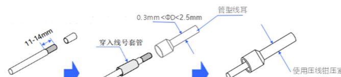
图 6 线缆制作示意图
